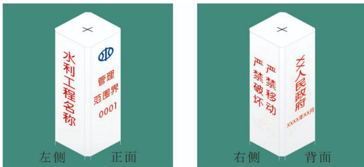
图 4.5-4 界桩标注样式示意图
